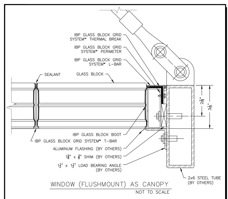
ALL STEEL SURFACES THAT COME INTO CONTACT WITH THE ALUMINUM GRID SYSTEM SHOULD BE PAINTED WITH RED OXIDE PRIMER (OR EQUIVALENT) TO ENSURE AGAINST ELECTROLYSIS.
